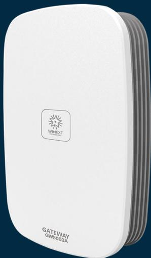
LoRa网关 (Gateway) 主要负责将各种终端节点的数据传输给云平台服务器，也就是完成数据从LoRa无线方式到TCP/IP网络方式的转换。网关本身并不对数据做处理，只是负责将数据打包封装，然后传输给云平台服务器。根据不同环境的实际部署条件，网关可灵活选择以太网、3/4G蜂窝网等传输方式连接到云平台。
